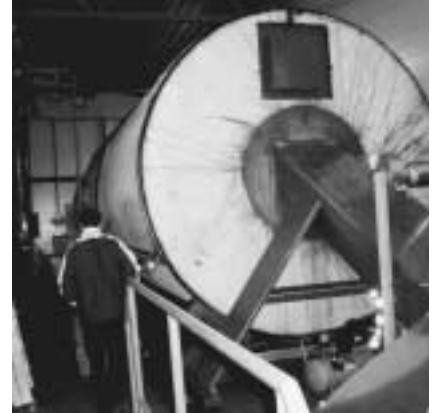
Einsatzplätze für den vorteilhaften Einsatz von Funksensoren: (a) Rohrsystem und Behälter in der Lebensmittelindustrie, (b) Prozessanlage zur Kompostierung in rotierenden Behältern.
