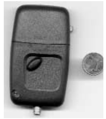
Sender und Empfänger der Sensorfunk-Module Senbit. Die Abbildung zeigt die Laborausführung, die aus ergonomischen Gründen in ein handhabbares Gehäuse verbaut wurde. Eine deutliche Verkleinerung der Abmaße für stationäre Systeme mit geringem Platzangebot, bis hin zur vollständigen Integration in den Messkopf ist möglich.
